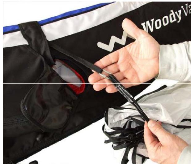
На этой подвесной системе тормозной парашют можно вводить двумя способами. Различие между ними обусловлено разной техникой использования парашюта.
