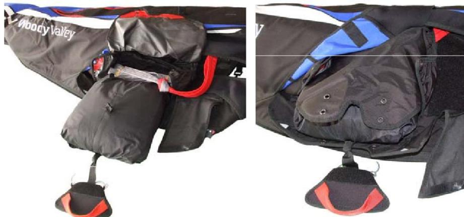
Вставьте тонкую стропу (диаметром один или два миллиметра) в обе эластичных петли, которые будут использоваться для зачековки парашюта. Проденьте их через два небольших отверстия в верхнем клапане парашюта, выбрав те, которые лучше всего подходят под размер вашего парашюта. Далее закройте боковые и нижний клапан контейнера и проденьте стропы через них так, как указано на фотографиях ниже.
