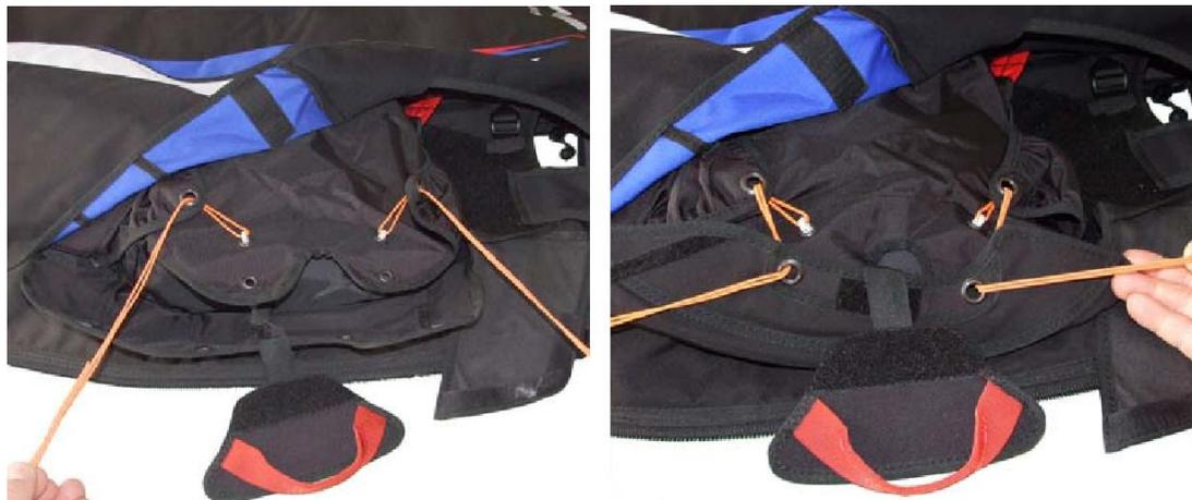
Вставьте металлические шпильки ручки парашюта в эластичные петли. После этого, необходимо удалить тонкую стропу. Этот момент очень важен. Вытаскивайте стропу медленно и аккуратно, чтобы не повредить эластичные петли избыточным трением. После этого, вставьте рукоятку внутрь специального кармана. Закройте верхний декоративный клапан так, чтобы он сидел плотно и закрывал застежку Велкро ручки парашюта.
